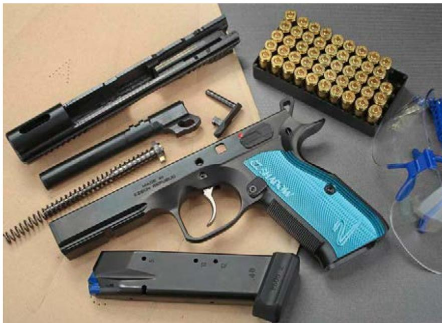
Die Baugruppen der CZ Shadow 2 von oben nach unten: Schlitten, Rampenlauf, Schließfeder mit Führungsstange, Schlittenfanghebel, Griffstück und Magazin.
